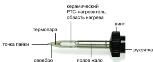
Рис. 8. Паяльное жало ERSA 612 в разрезе
