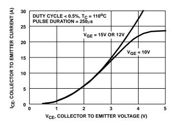
FIGURE 16. COLLECTOR TO EMITTER ON-STATE VOLTAGE
