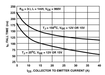
FIGURE 12. FALL TIME vs COLLECTOR TO EMITTER CURRENT
