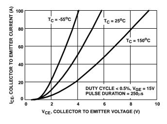
FIGURE 6. COLLECTOR TO EMITTER ON-STATE VOLTAGE
