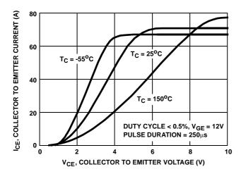
FIGURE 5. COLLECTOR TO EMITTER ON-STATE VOLTAGE
