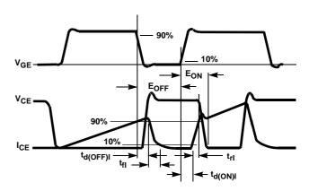
FIGURE 21. SWITCHING TEST WAVEFORMS
