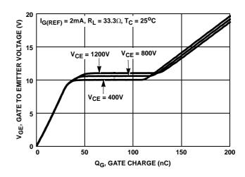
FIGURE 14. GATE CHARGE WAVEFORMS
