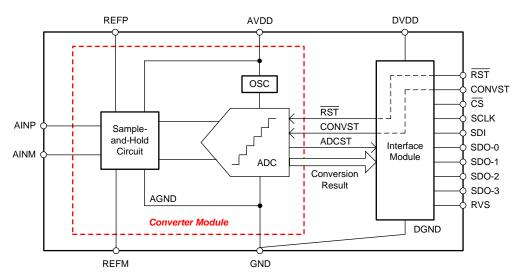
Figure 31. Converter Module
